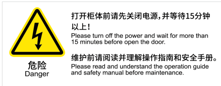
图 1-6 开门断电&维护指示牌
